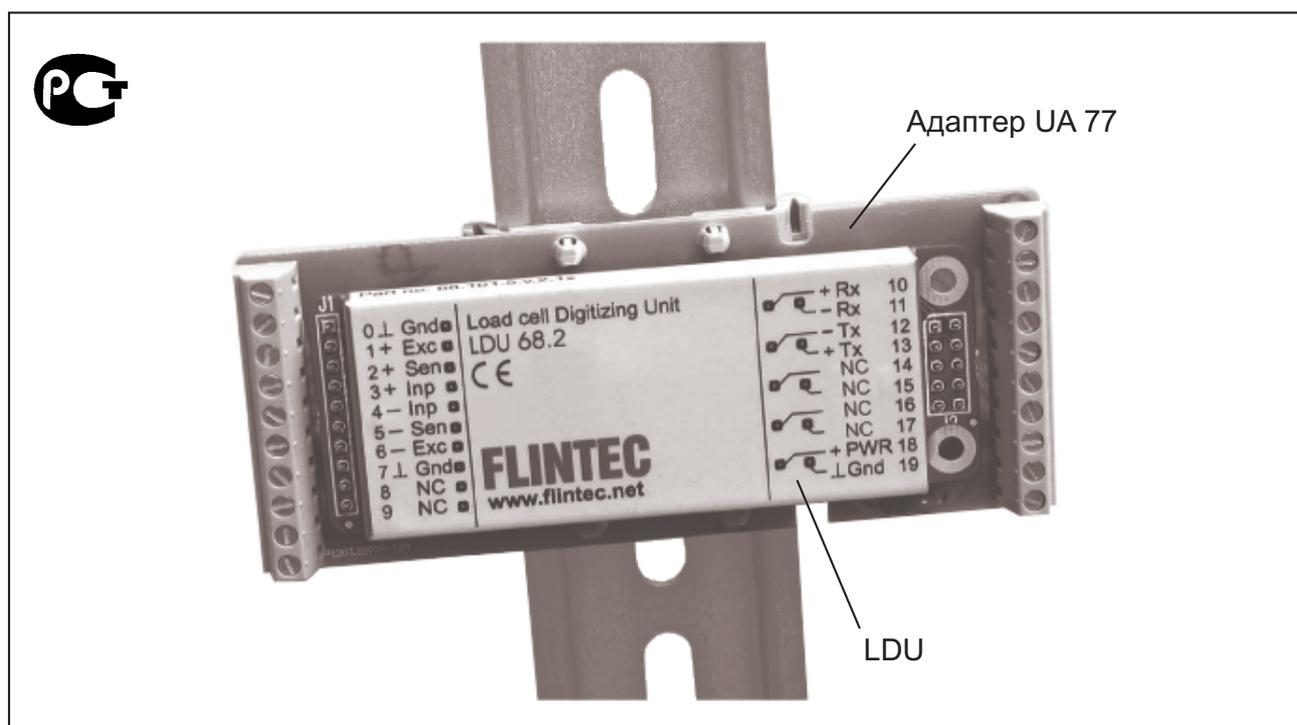
Тензопреобразователи серии LDU 68.1/68.2 предназначены для преобразования и нормирования аналогового сигнала (мВ) от полностовых тензодатчиков в цифровую форму. Трансляция цифрового сигнала на внешние устройства осуществляется по штатному порту связи RS422/485.
