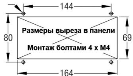
Вырез под панельное исполнение.
