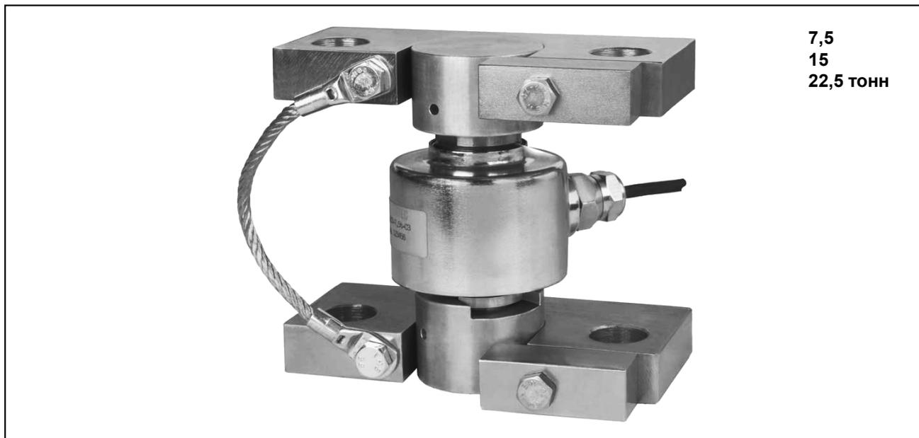
Узел встройки маятникового типа для датчика RC1 позволяет максимально точно передавать полезное усилие от металлоконструкции весов на чувствительный элемент.
