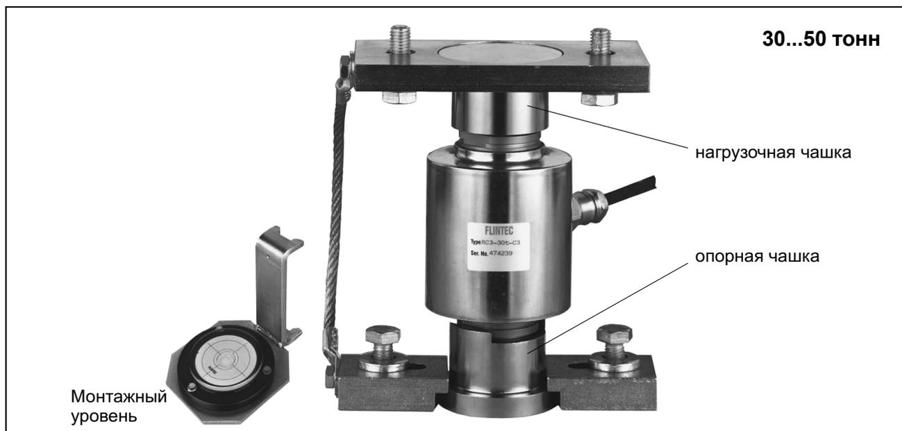
Узел встройки маятникового типа для датчиков RC3, RC3D позволяет максимально точно передавать полезное усилие от металлоконструкции весов на чувствительный элемент.
