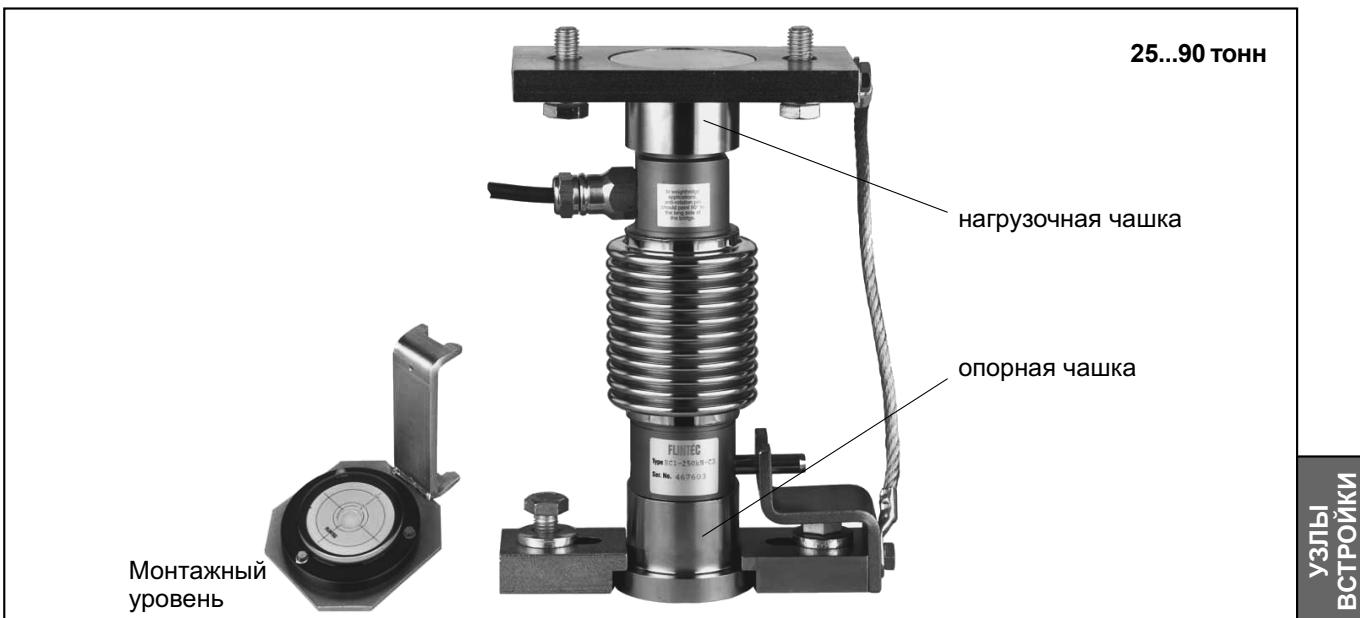
Узел встройки маятникового типа для датчика RC1 позволяет максимально точно передавать полезное усилие от металлоконструкции весов на чувствительный элемент.
